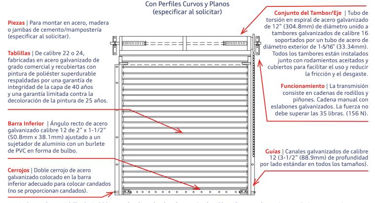
La Puerta Comercial Slat Serie 300 con trabas laterales de nylon y guías de calibre 12 es una alternativa económica que permite un mantenimiento y servicio fácil. La cortina viene montada en el tambor desde fábrica para facilitar y acelerar la instalación. La Serie 300 es la elección perfecta para terminales de carga, comercios y otras aplicaciones industriales.
