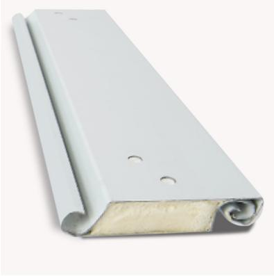
**PERFIL PLANO:** fabricado en acero galvanizado de calidad comercial y recubierto con pintura de poliéster súper duradera, respaldada por una garantía de integridad de la película de 40 años y de 25 años de pintura sin decoloración. Espuma de poliuretano inyectada, con un valor de aislamiento efectivo de R=7,2.
