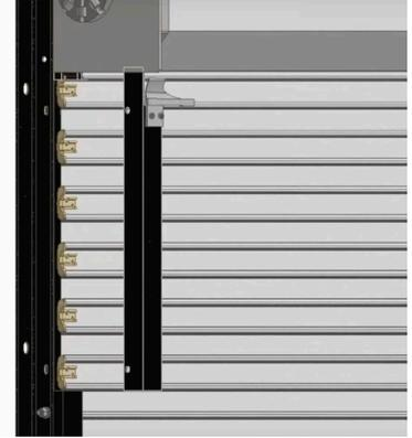
**GUÍAS:** ángulos de acero estructural con un espesor mínimo de 3/16", con topes superiores removibles y recorte de servicio de 30". La profundidad de la guía permite la penetración del listón según la carga de viento especificada.
