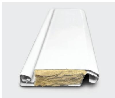
**PERFIL DE LAMAS:** Fabricado con acero galvanizado de grado comercial y recubierto con pintura de poliéster superdurable, respaldada por una garantía de 40 años sobre la integridad de la película y 25 años contra la pérdida de color. Aislamiento térmico de lana mineral, con un valor de aislamiento efectivo de R = 4.7.
